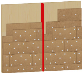
Zweilagige Montage auf Massivholz
