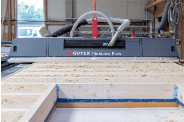
*Messeneuheit auf der Dach+Holz 2024: GUTEX Fibreblow Plate, die erste speziell für lose Holzfasern entwickelte Einblasplatte. Sie ist wesentlicher Bestandteil der Systemlösung GUTEX Fibreblow. Der Hersteller bietet alles aus einer Hand an – vom Holzfaser-Einblasmaterial bis zur perfekt darauf abgestimmten Anlagentechnik.*
