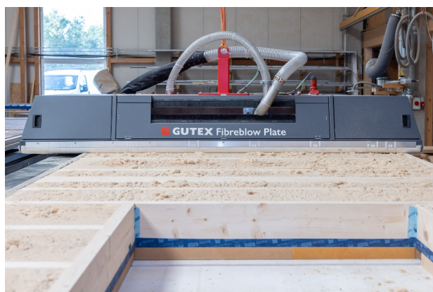
Abb. 1 Messeneuheit auf der Dach+Holz 2024: GUTEX Fibreblow Plate, die erste speziell für lose Holzfasern entwickelte Einblasplatte. ©GUTEX/Martin Granacher
