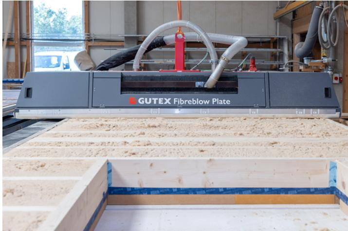
*GUTEX Fibreblow Plate ist die erste speziell für lose Holzfasern entwickelte Einblasplatte.
