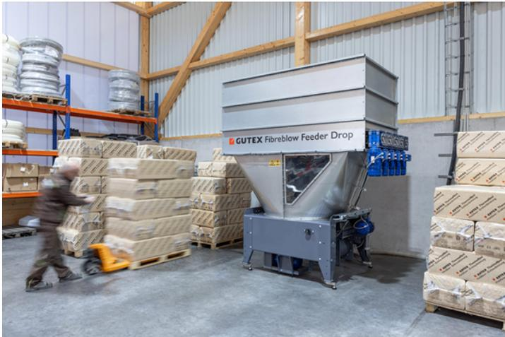
*Mit GUTEX Fibreblow Feeder Drop können Verarbeiter in der Vorfertigung und beim seriellen Sanieren noch größer planen: Das Vorratsvolumen kann kundenspezifisch skaliert werden und beträgt mindestens 3 Großballen.
