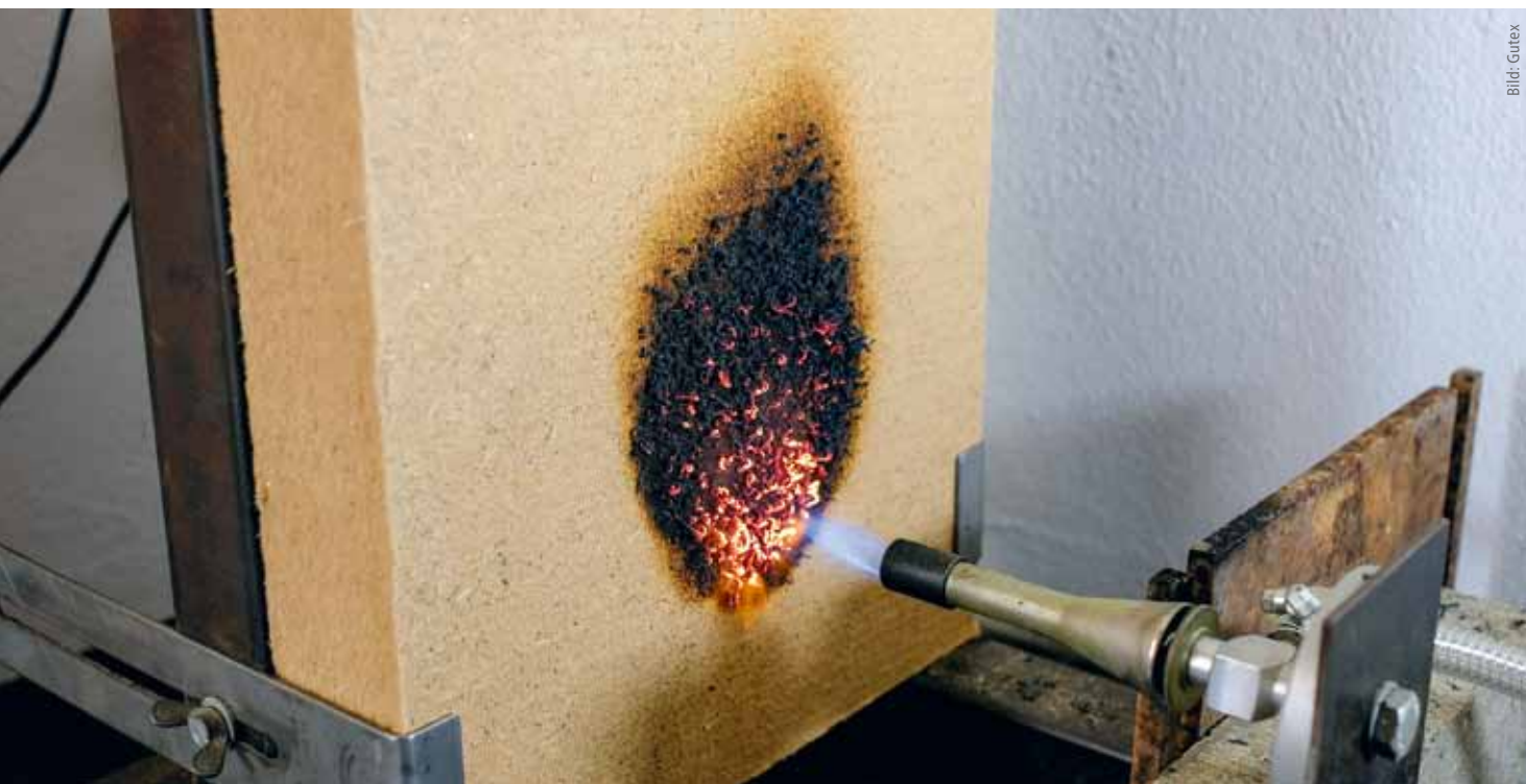
Der Brandtest im Werk der herstellenden Firma zeigt, wie sich der Schutzmechanismus der Platte entfaltet.
